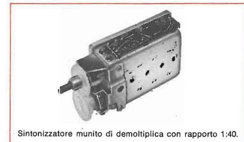
Sintonizzatore munito di demoltiplica con rapporto 1:40.
